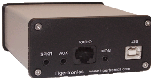
Realizarea internă și panoul din spate pentru Signalink USB
