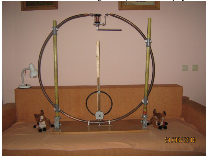
Fig. 7 – Antena și bucla de cuplaj inductiv în ansamblul funcțional (cu veverițe de pluș... hi)
